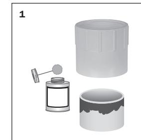
Coller l'adaptateur au tuyau à l'aide d'une colle à solvant appropriée.
