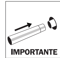
PASO 6 Verifique en seco el buen ajuste de la extensión para asegurarse de que quede enteramente dentro del tubo de cobre en la pared.
